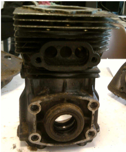
Cylindre complet avec les trois lumières d'échappement et l'emplacement du vilebrequin.
