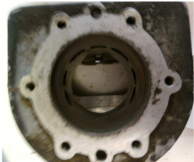
Intérieur du cylindre avec deux lumières d'admission, les trois lumières d'échappement et les deux autres lumières d'admission
