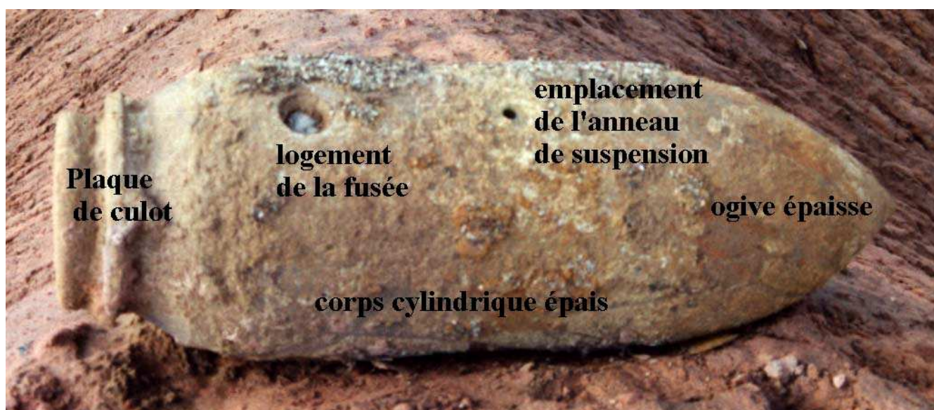
Bombe allemande à paroi épaisse de la seconde guerre mondiale type SD 500
