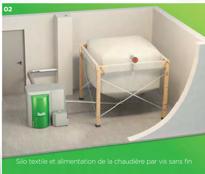
Pièce de réserve et alimentation de la chaudière par vis sans fin
